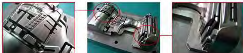
金型(冷却用水管)((株)松浦機械製作所の好意による)
