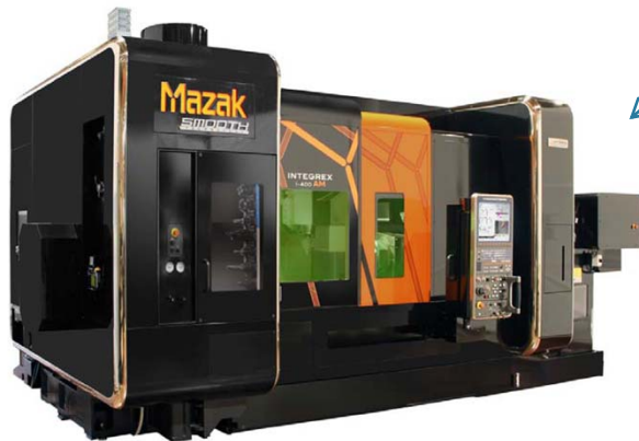
ヤマザキマザック(株) INTEGRIX i-400 AM 5軸複合加工機+DEDタイプの3Dプリンタ
