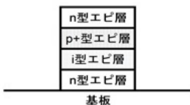
\* i型はアンドープとも呼ばれ、"層"の名称はその役割で決められることが多く、多数ある。（傾斜層（grading）、ショットキー層、スペーサ層、バッファ層、チャネル層、電子供給層など）
