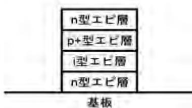
\* i型はアンドープとも呼ばれ、“層”の名称はその役割で決められることが多く、多数ある。(傾斜層 (grading)、ショットキー層、スペーサ層、バッファ層、チャンネル層、電子供給層など)
