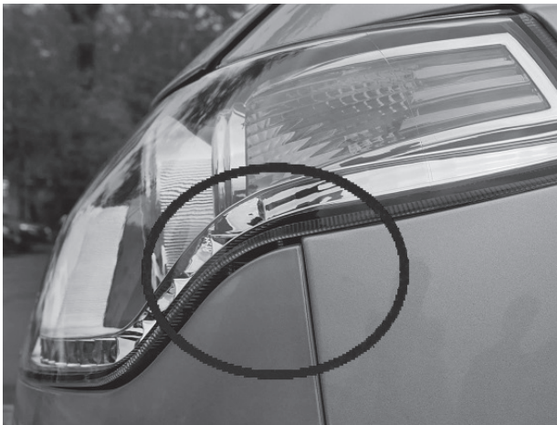
写真1 ロシア製自動車の品質 部品形状、組立の精度が悪いため、本来であれば連続しているべきラインに段差ができています。(著者撮影)
